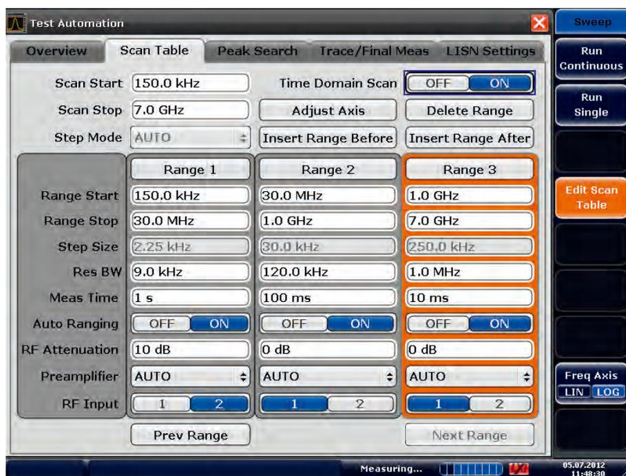
在RECEIVER接收机模式下可以根据扫描表中的设置调整R&S®ESR。可以使用可独立设置的参数(开始/停止频率、测量时间、分辨带宽、输入衰减等等)，针对最多十个频段范围对扫描表进行编程。
