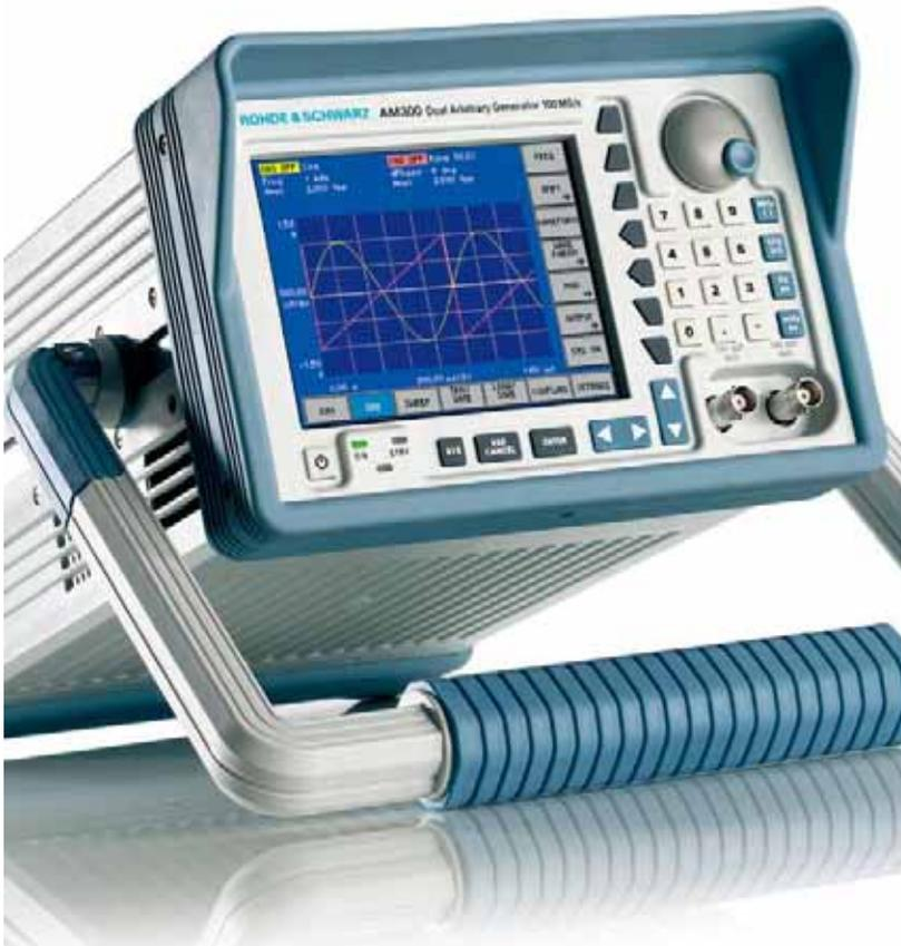
所有的仪器都基于300系列的机架，具有大致相同的面板。包括：5.4英寸的VGA TFT液晶显示屏，前面板控制区，护套，提把（可以调节到不同位置）。只有前面板的连接器是根据仪器的不同而定的。如果把护套和提把拆掉R&S® AM300可以安装在一个19英寸的机箱架上。这根据设计而定，两台300系列的产品可以被安装在一起。
